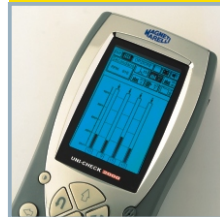
Test wysokiego napięcia
